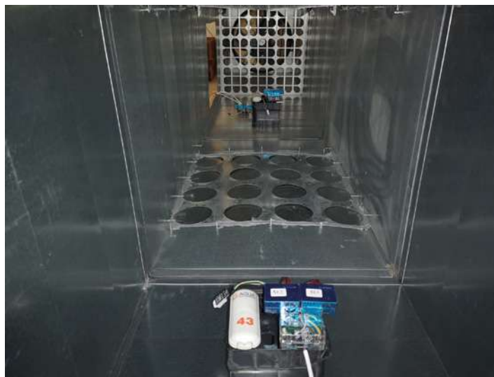
Foto 21: Situación de los sensores en el túnel del viento
