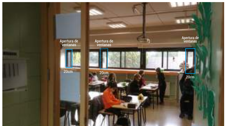
Foto 4: Apertura de puerta + ventanas (20 cm cada una).
